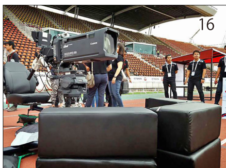
■セーフティ・クッション = 周囲に配置して、競技中のボールなどから、カメラやオペレーターを守ります。
