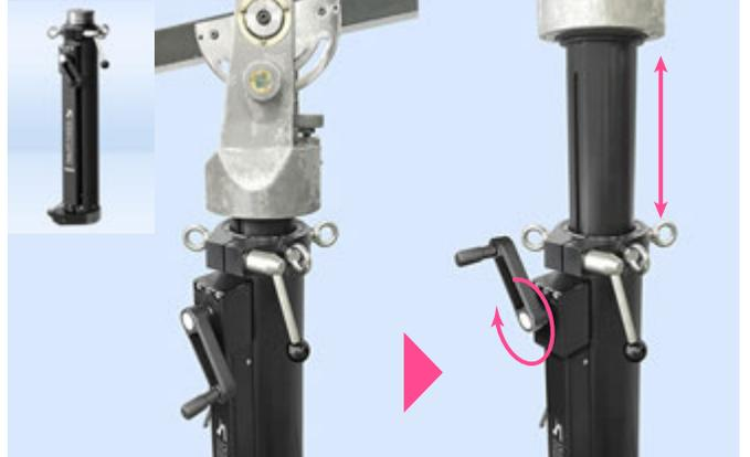
クランクを回してジブを取り付けたまま、上下の高さ変更ができます。耐荷重は150kgで、ミニジブ等、軽量のジブアームで使用可能。耐荷重制限により、重量型のテレジブは使用できません。
