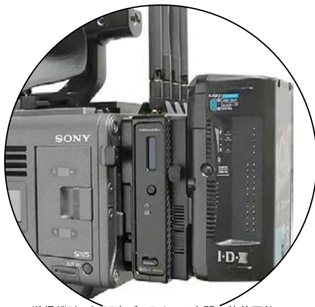
送信機は、カメラとバッテリーの間に装着可能
